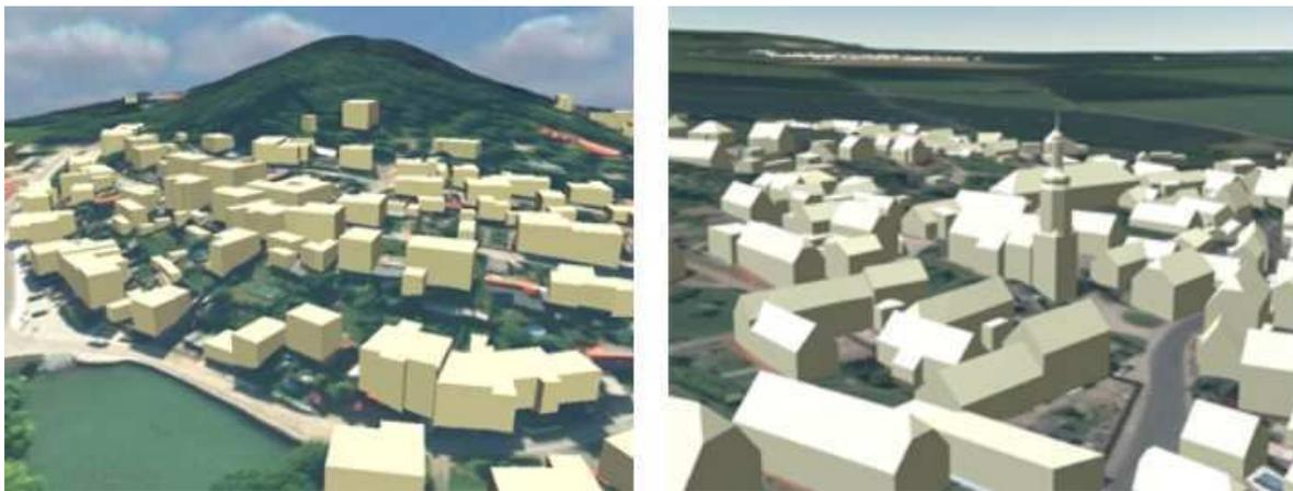
Abb. 51 LOD1-Modelle links und LOD2-Modelle rechts<sup>30</sup>
