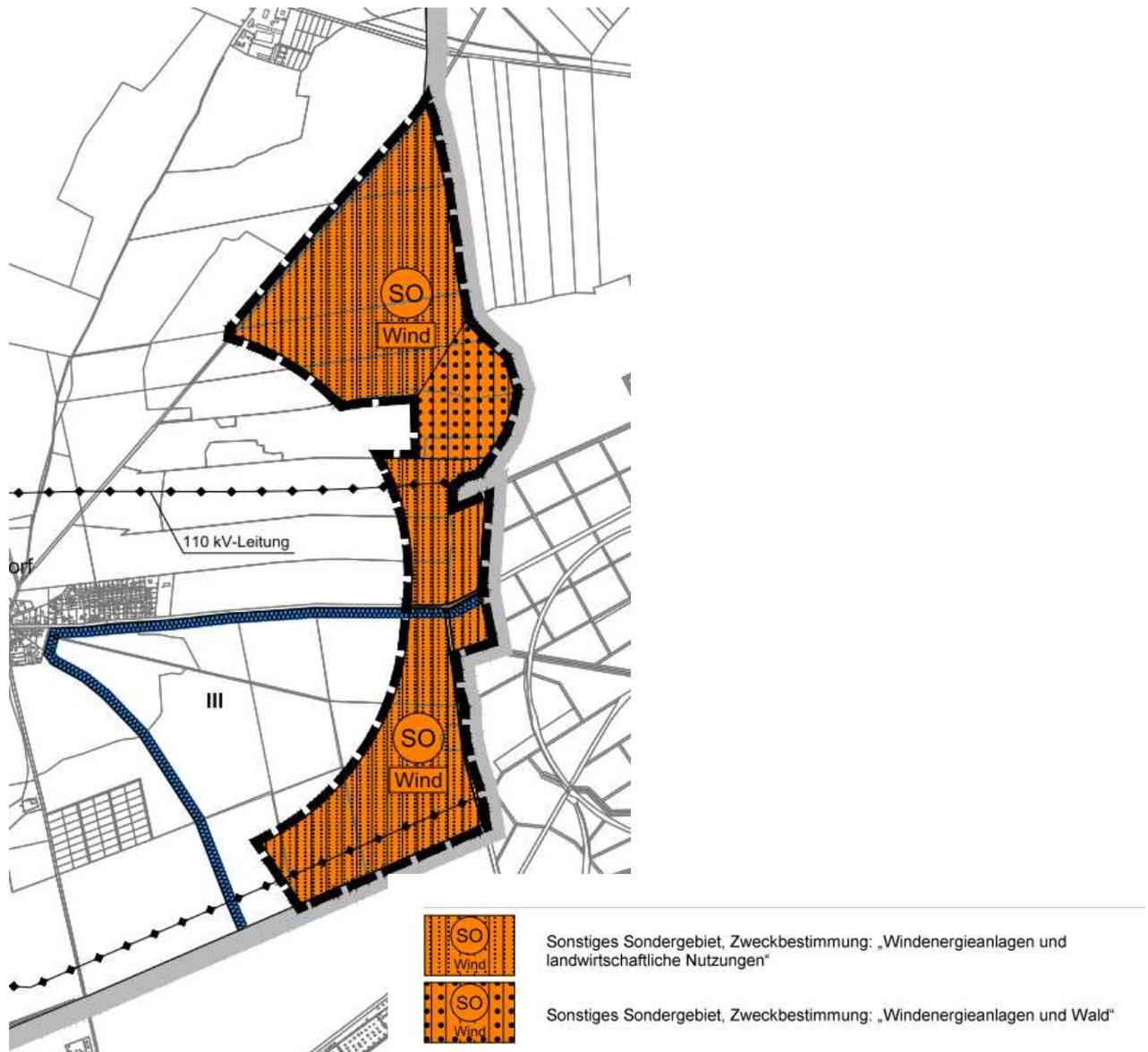
Abb.: Abgrenzung des Sonstigen Sondergebiets „Windenergienutzung“ im Sachlichen Teilflächennutzungsplan Wind; Entwurfsstand
